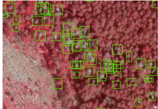
4.attēls. Fragments no YOLOv3 modeļa detektētajiem objektiem karšu lapā Nr.4233-43-23, t.i. ārpus aizsargājamām dabas teritorijām.
